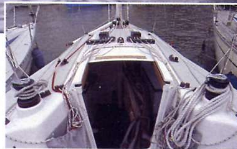
A sinistra, la disposizione delle rotaie genoa e dei bracci spi. Sopra, l'organizzazione delle drizze in Spectra.
