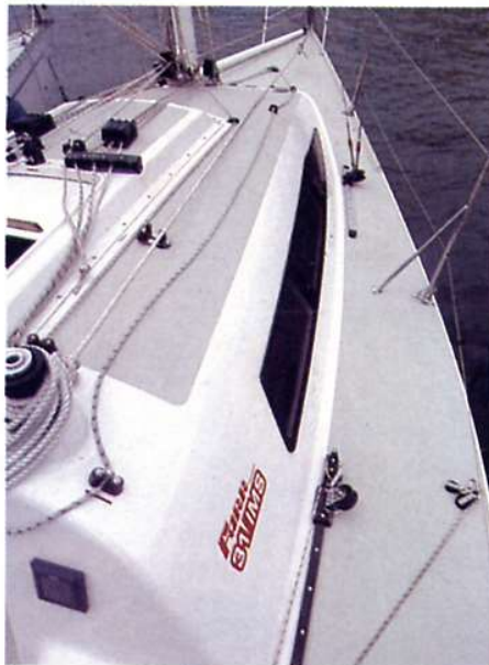
A sinistra, la disposizione delle rotaie genoa e dei bracci spi. Sopra, l'organizzazione delle drizze in Spectra.
