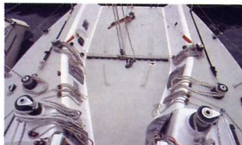
Sopra, le manovre di scotta e le volanti sono a cavallo del baglio massimo. A lato, le cuccette e l'alloggiamento dell'ancora.
